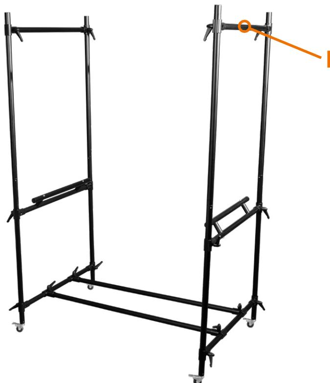
Verbinden Sie nun die beiden Seiten mit 2x E oben bündig an der Konstruktion. Achten Sie darauf, dass Sie die vier Tischbeine, bestehend aus G und F, nun parallel zueinander stehen und senkrecht nach oben ausgerichtet sind. Positionieren Sie die beiden Stangen I so knapp wie möglich unter E. Wenn der Tisch spannungsfrei ist und gerade steht, können Sie die betreffenden Klemmhebel A final fixieren.
